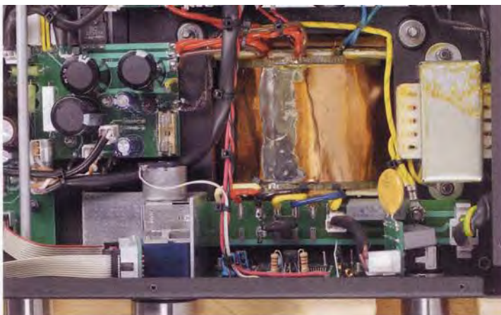
Mächtig: Für stabilen Betrieb brauchen Trioden riesige Netzteile. Eine Siebdrössel (rechts) glättet die Anodenspannung zusätzlich.
