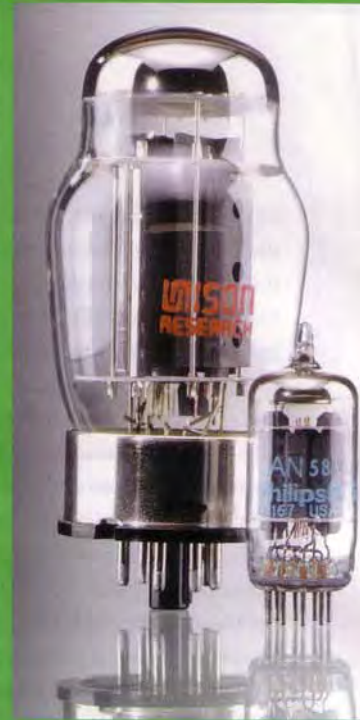
Trotz single-ended und Class A: Die kleine ECC 82 (Philips USA) und die große KT 88 (Sovtek) bringen stattliche 16 Watt an die Lautsprecherklemmen. Das reicht den meisten Boxen.
