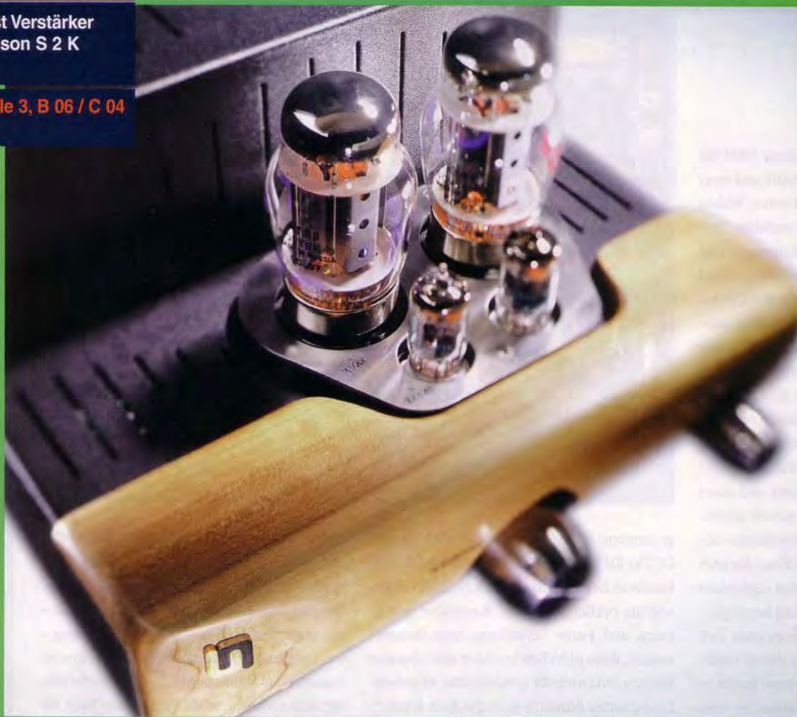
Trotz single-ended und Class A: Die kleine ECC 82 (Philips USA) und die große KT 88 (Sovtek) bringen stattliche 16 Watt an die Lautsprecherklemmen. Das reicht den meisten Boxen.
