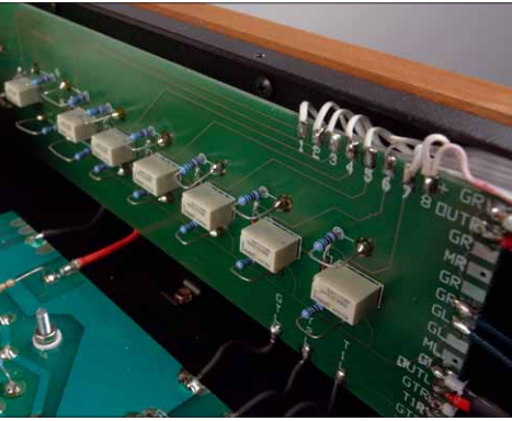
Eingangssignale werden mit Relais direkt vor Ort geschaltet
