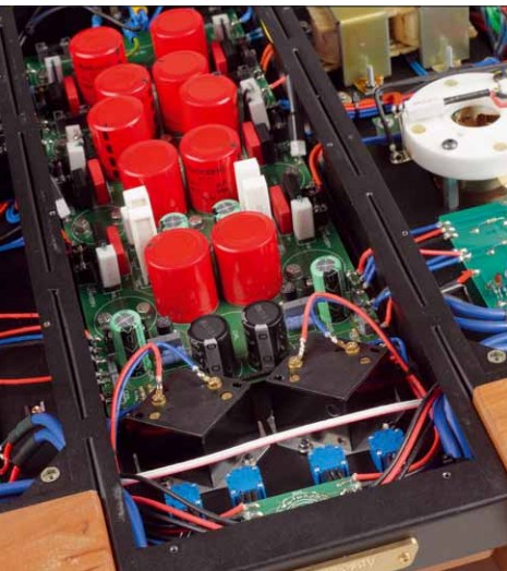
Das mittlere Abteil des Gerätes ist im Wesentlichen der Stromversorgung vorbehalten
