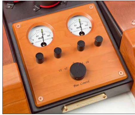
Das Schwarze muss ins Grüne: Die Ruhestromeinstellung für die Endröhren ist denkbar simpel
