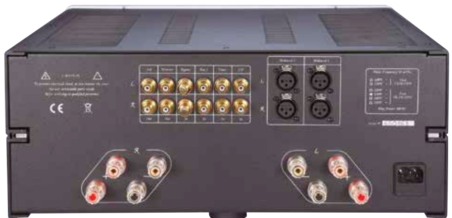
▲ Neben symmetrischen und unsymmetrischen Anschlüssen stehen ein Subwooferausgang und ein Endstufen-Direkteingang auf der Habenseite.
