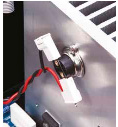
▲ Die Endstufen nutzen großzügige Kühlkörper und werden thermisch kontrolliert.
