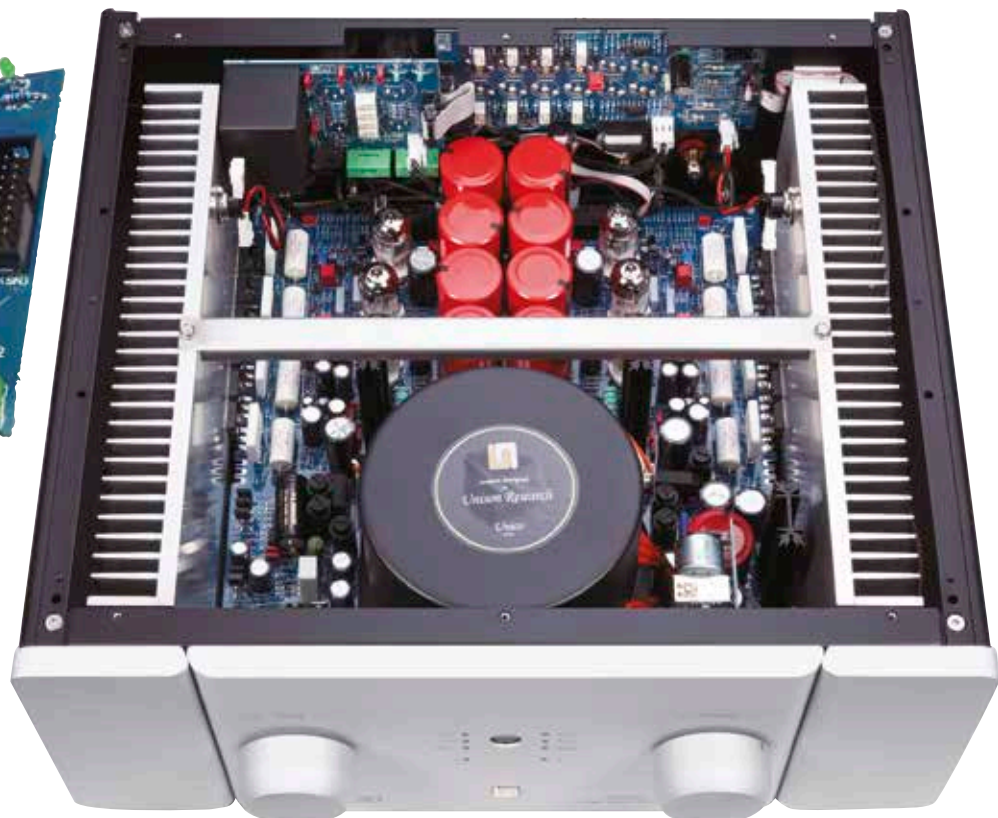
▲ Die Endstufen nutzen großzügige Kühlkörper und werden thermisch kontrolliert.
