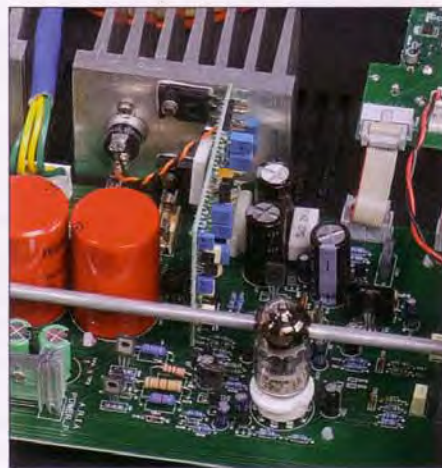
Miteinander: (Vorstufen-) Röhre und (End-) Transistor sind im Unison vereint.
